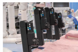
オペレーションユニットの8軸のアーム
